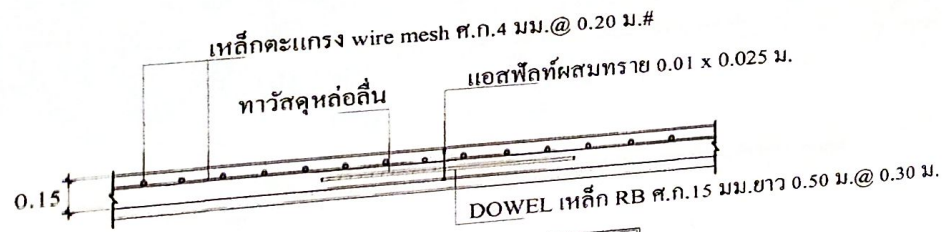
ขยาย CONTRACTION JOINT Scale 1:25
