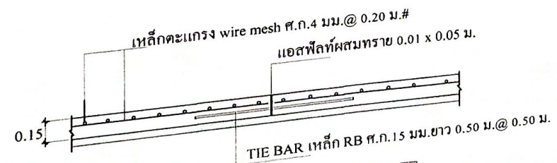
ขยาย LONGTUDINAL JOINT Scale 1:25
