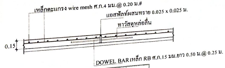
ขยาย EXPANSION JOINT Scale 1:25
